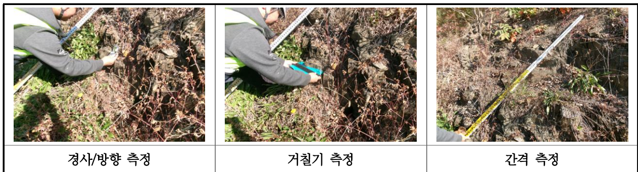
【사진 35.3.2】 불연속면 측정 현황
